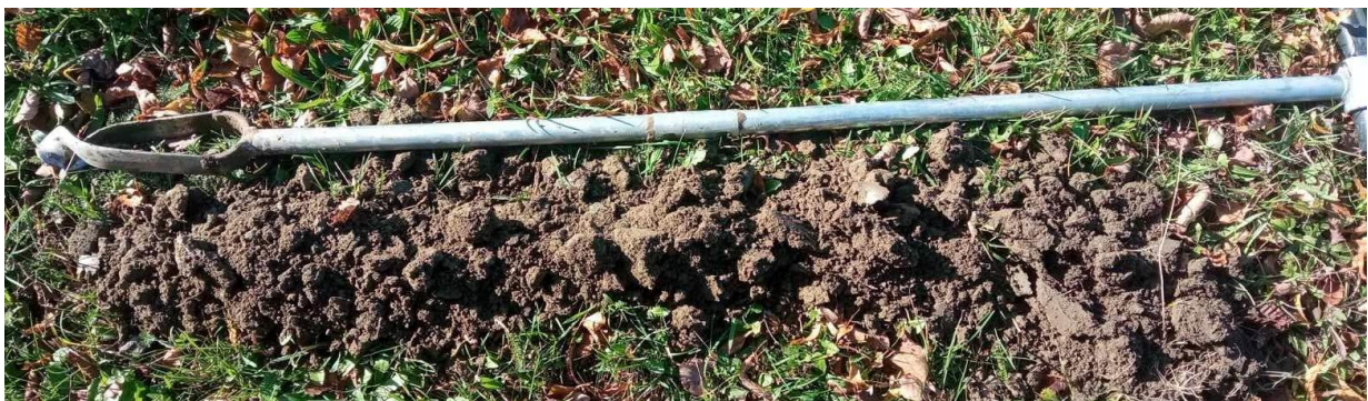
Obr. 3 Půdní profil sondy S-3 umístěné v blízkosti silnice č. 368 zastihující více než 1,1 m mocnou vrstvu prachovitých hlín (foto M. Skalický)
