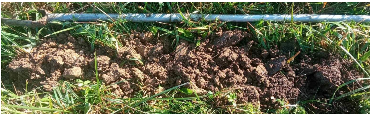
Obr. 2 Půdní profil sondy S-1 umístěné v blízkosti hřbitova. Mocnost prachovitých hlín dosahuje 0,25 m a jejich podloží se nacházejí jílovité hlíny s kameny (foto M. Skalický)
